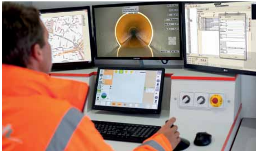
1 pav. RCA 4.0: Full HD signalo kurio raiška 1920x1080 pikselių perdavimas per varinį kabelį be optinio pluošto gijų, programinė įranga „PipeCommander“ ir „Pico Maps“
