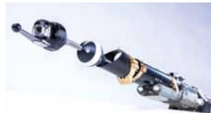
4 pav. LATRAS: trasų vietos nustatymo sistema automatiniam matavimui ir grafiniam vamzdinių atvaizdavimui skaitmeniniuose žemėlapiuose
