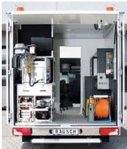
3 pav. Konteinerio tipo antstatas su TV diagnostikos įranga RCA 4.0, satelitinė sistema ir sandarumo tikrinimo sistema
