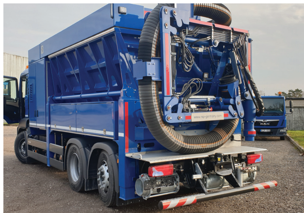
1 pav. Vakuuminis ekskavatorius. Jo kombinuotų ventiliatorių siurbimo principas užtikrina geriausią gravitacinį nusodinimą, mažiausią filtrų apkrovą ir tuo pat metu – didžiausią tolygų siurbimo galingumą. Oro srovė per siurbimo žarną įtraukia bet kurią medžiagą, kurios kietųjų dalių skersmuo neviršija 250 mm. Surinkimo rezervuare, nutraukus oro srovę ir sukimasi, visos stambios dalys nusėda. Oras, einantis pro nusodinimo kamerą, toliau valomas ir džiovinamas. Oro filtrai absorbuoja likusias dulkes ir išvalytas oras pro garso slopintuvą išstumiamas aukštyn į aplinką.
