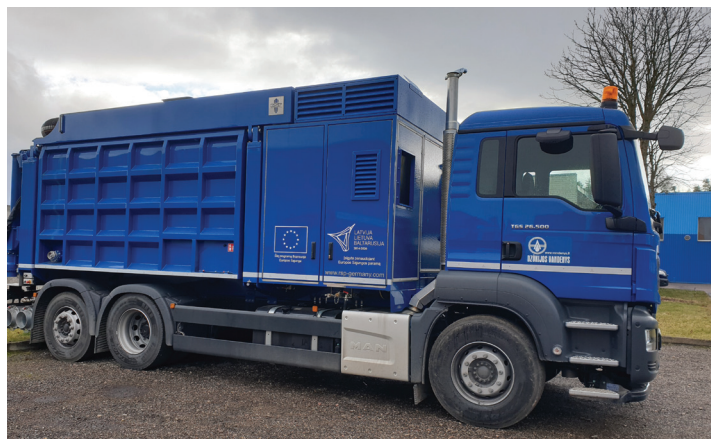
1 pav. Vakuuminis ekskavatorius. Jo kombinuotų ventiliatorių siurbimo principas užtikrina geriausią gravitacinį nusodinimą, mažiausią filtrų apkrovą ir tuo pat metu – didžiausią tolygų siurbimo galingumą. Oro srovė per siurbimo žarną įtraukia bet kurią medžiagą, kurios kietųjų dalių skersmuo neviršija 250 mm. Surinkimo rezervuare, nutraukus oro srovę ir sukimasi, visos stambios dalys nusėda. Oras, einantis pro nusodinimo kamerą, toliau valomas ir džiovinamas. Oro filtrai absorbuoja likusias dulkes ir išvalytas oras pro garso slopintuvą išstumiamas aukštyn į aplinką.
