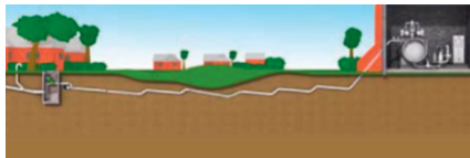
1 pav. FLOVAC vakuuminės kanalizacijos tinklai
