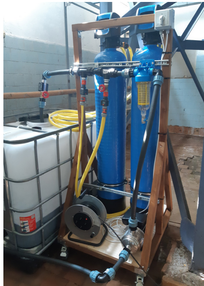
3 pav. Mobiliojo filtravimo įrenginio prototipas, skirtas neskaidiems azo dažikliams ir sunkiesiems metalams iš vandens valyti
