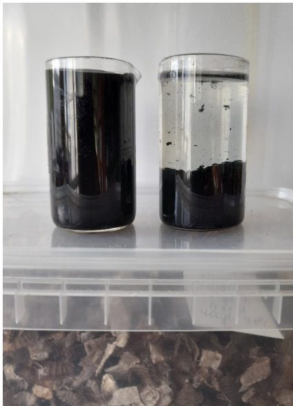
2 pav. Vandens, užteršto juodais azo dažikliais, pasyvu valymas, pritaikius chitino / chitozano pagrindu pagamintą sorbentą
