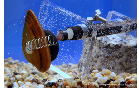
3 pav. Matavimo zondai fiksuoja midijos kiauto atsivėrimo laipsnį ir vandens temperatūrą
