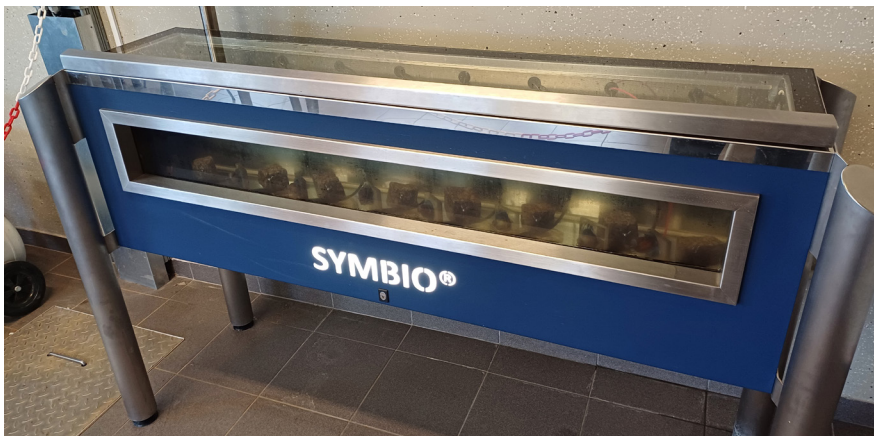
2 pav. Rezervuaras. Pagamintas iš nerūdijančiojo plieno ir sukurtas siekiant pašalinti arba sumažinti tokių veiksmų įtaką, kurie galėtų neigiamai paveikti midijų veiklą. Į SYMBIO rezervuarą dedami 8 midijų individai
